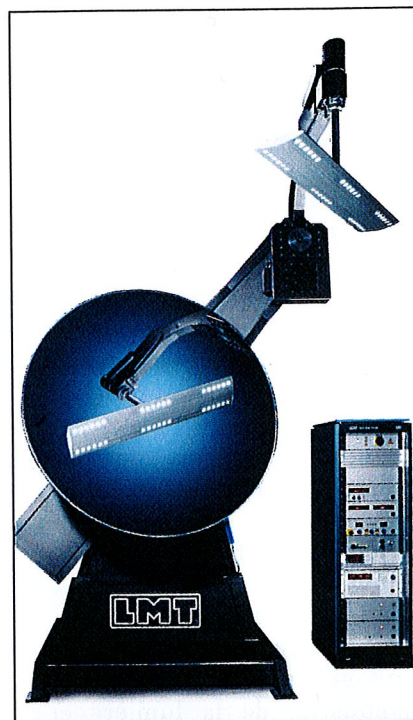
Exemples de prestations technologiques de PISEO : la mesure de la distribution de l'intensité lumineuse émise par une source ou un système d'éclairage dans toutes les directions de l'espace par un gonio-photomètre (PISEO est la seule plateforme privée à avoir cet équipement).
