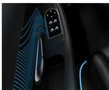
Fibre optique tissée et guide lumineux Source : EFI Lighting, 2017
