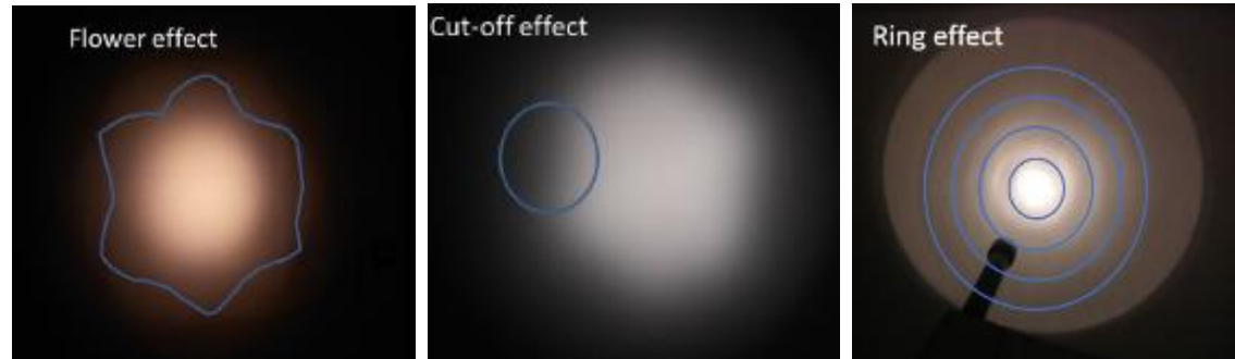
Illustration des défauts de faisceau : Flower effect, cut-off effect, ring effect
